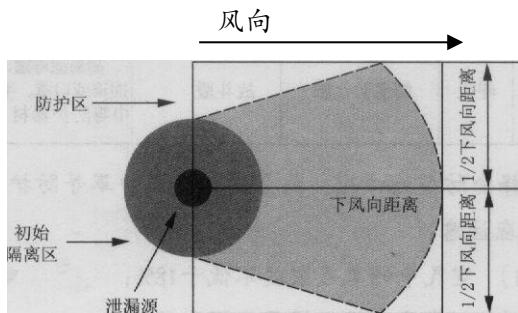
手册中给出的初始隔离距离、下风向疏散距离适用于泄漏后最初 30min 内或污染范围不明的情况下，参考者应根据事故的具体情况如泄漏量、气象条件、地理位置等做出适当的调整。
