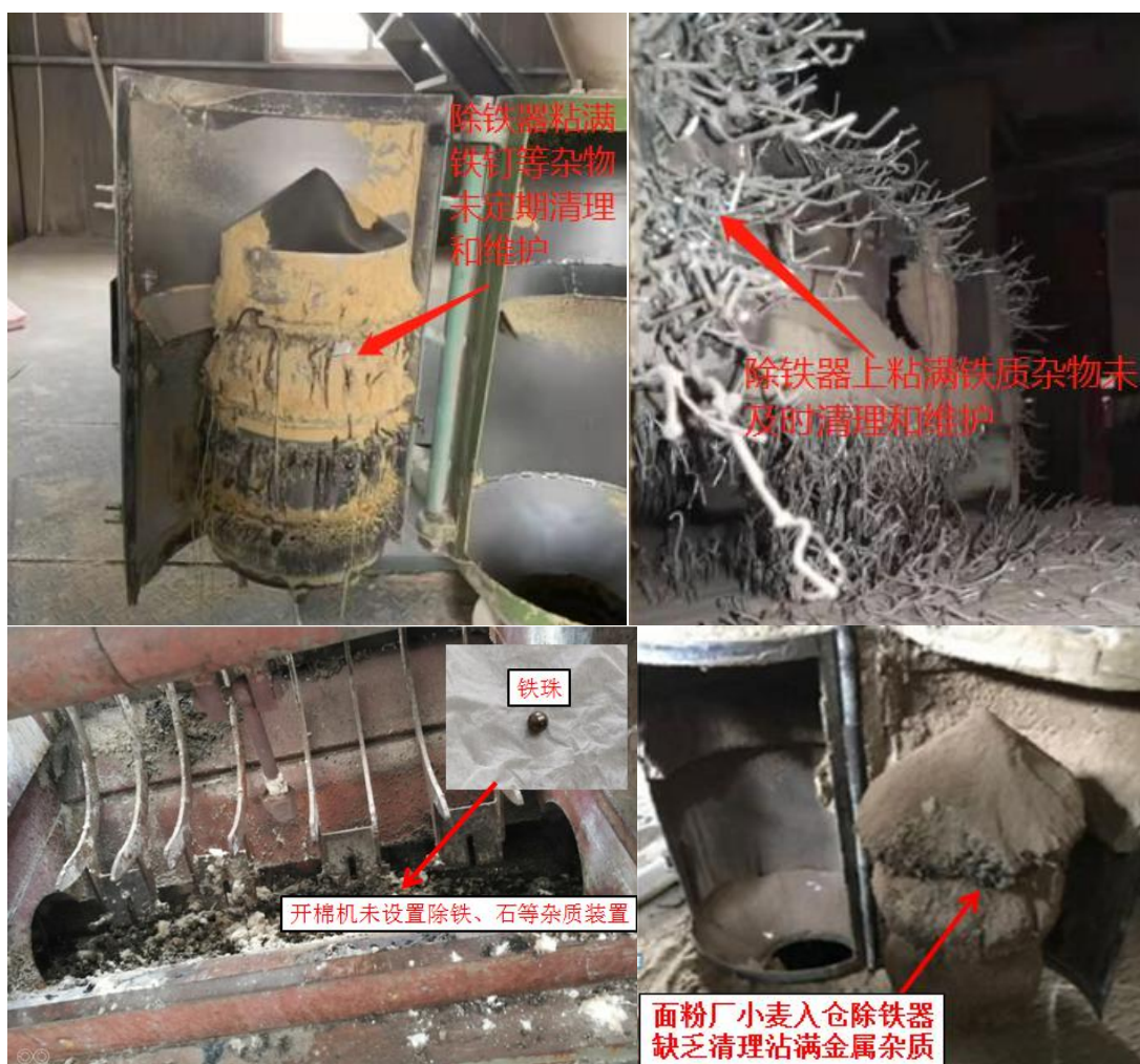
未设置或者维护不到位的除铁除杂装置（✖）
