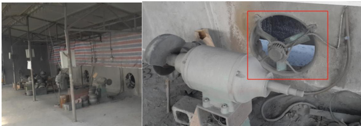
常见典型的金属抛光打磨粉尘的直排除尘（✖）
