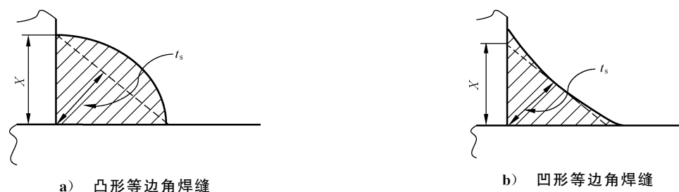
图 20 角焊缝的形式和尺寸
