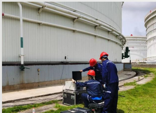
腐蚀在线声发射检测
