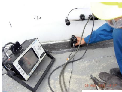
腐蚀在线声发射检测
