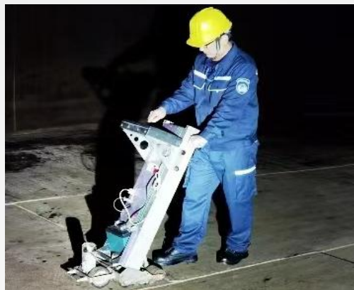
罐底板漏磁检测
